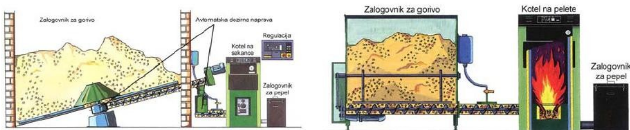
Slika 33: Kotel na lesne sekance in kotel na pelete.
